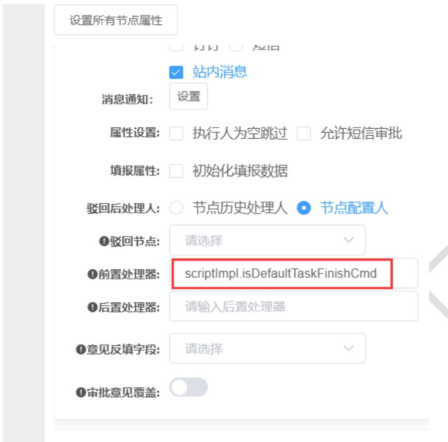
如下图所示,在该节点上用户进行审批操作时会先触发前置处理器,后触发后置处理器,如下面的代码断点所示。
