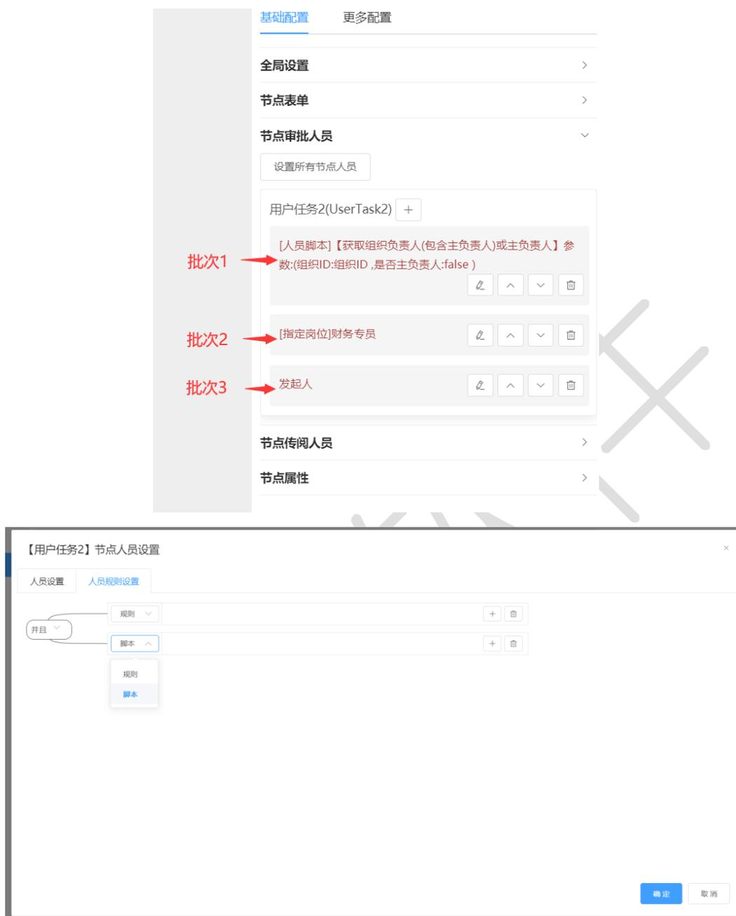
人员规则设置是一个可视化的配置界面，可以自由组合多种条件，包括规则和脚本，规则的配置比较直观易懂，脚本则支持通过 Groovy 代码进行逻辑判断，如下图所示，脚本中需要返回 true 或者 false。
